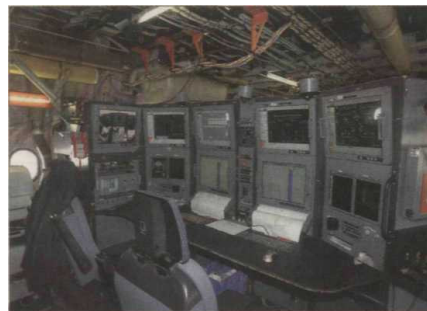
300 000 paramètres sont enregistrés en continu depuis cette station pour les ingénieurs navigants, et sont envoyés à Toulouse.
