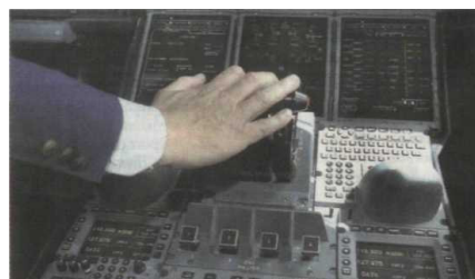
Le saint des saints, le cockpit : 8 écrans et 2 latéraux, 4 manches latéraux, 4 manettes de gaz pour les 4 moteurs Rolls-Royce...
